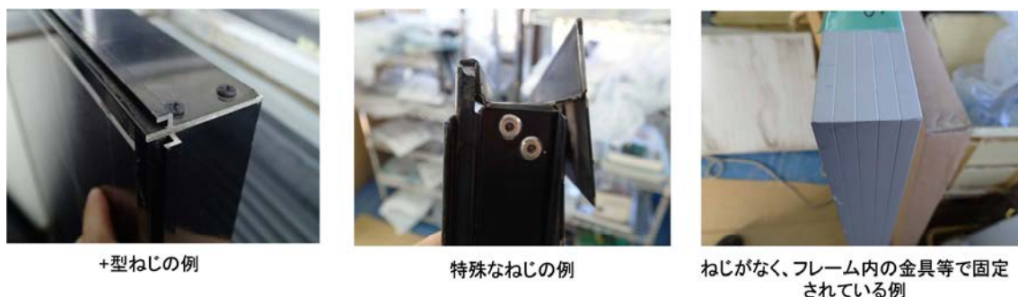
図 1-27 モジュールの解体性に関する状況
