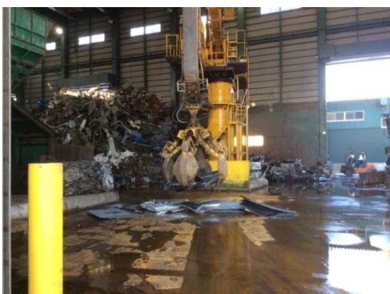
図 1-10 ロードラーでシュレッダーに投入
